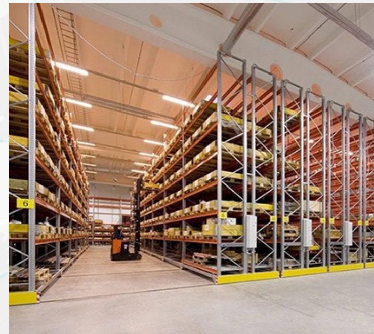
Hệ thống rack di động
